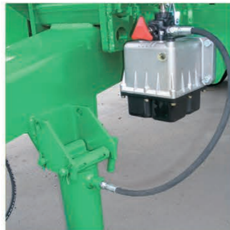
APOYO HIDRÁULICO CON BOMBA MANUAL/ HYDRAULIC FOOT WITH MANUAL PUMP
