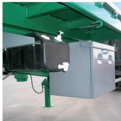
DEPÓSITO Y CAJÓN/ WATER DEPOSIT AND TOOL BOX
