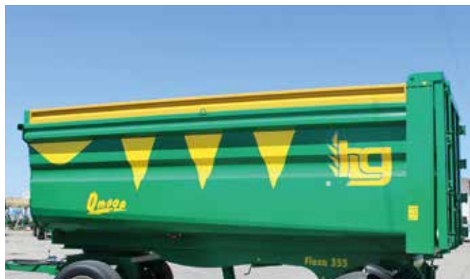
• Parte superior pliegue de refuerzo cerrado Máster 180 y 210 Upper part reinforced fold closed. Master 180 and 210
