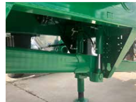
• Amortiguación hidráulica en lanza (opcional) Hydraulic suspension on the drawbar (optional)
