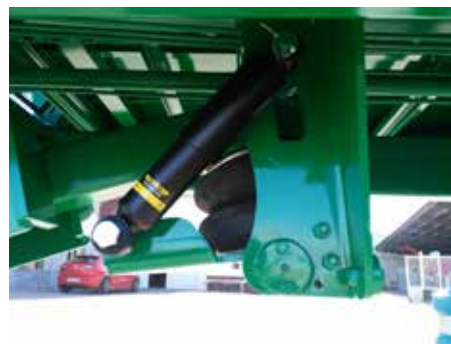
• Amortiguación Neumática en lanza (opcional) Pneumatic suspension on the drawbar (optional)
