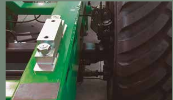
Celulas de pesaje // Weighing cells
