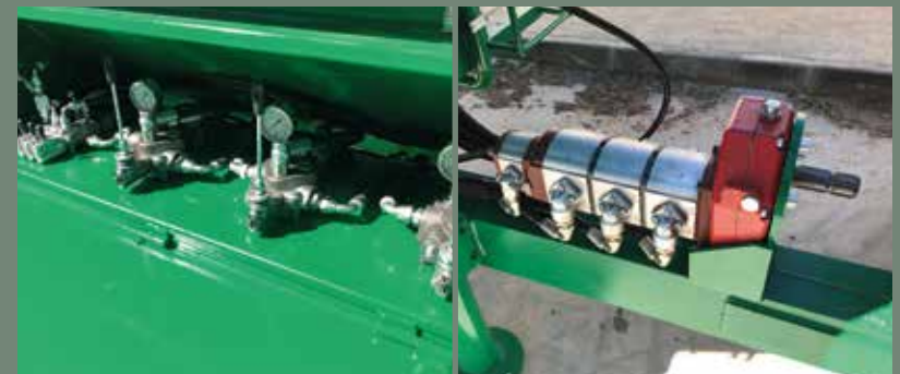
Bombas y mandos hidráulicos // Hydraulic pumps and controls
