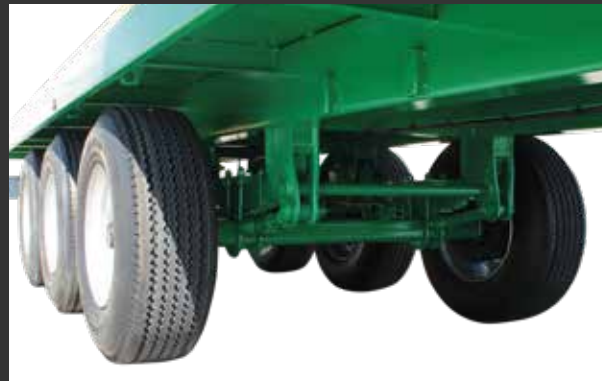
6 ballestas trídem tensores 6 tridem crossbows with tensioners
